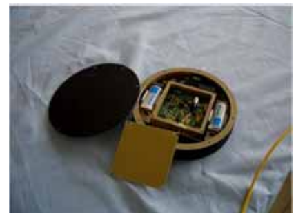
Fig.3 Photo of analog optical fiber probe 图 3 光纤电场测量系统探头内部实物图
