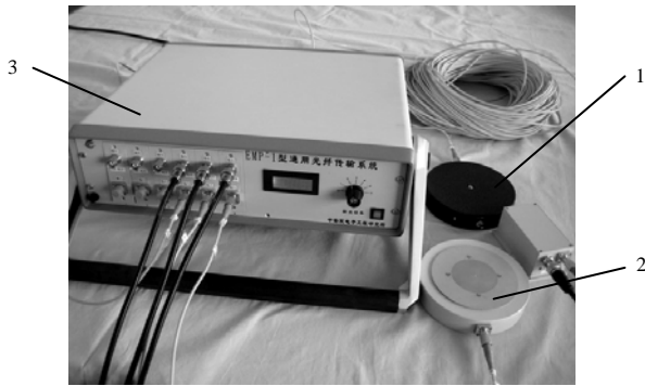
Fig.4 Photo of multifunctional analog optical fiber system 图 4 多功能模拟量光纤测量系统实物图
