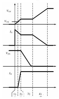
Fig.1 MOSFET turn-on time intervals 图 1 MOSFET 导通时序图
