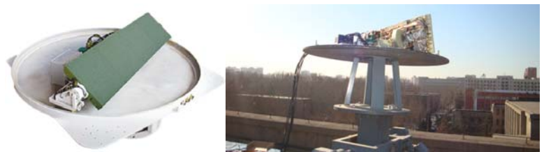
Fig.4 CTI-CM60-Ku2304 0.6 m panel antenna for communication on the move 图 4 CTI-CM60-Ku2304 型 0.6 m 平板动中通天线
