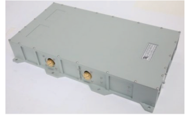
Fig.9 Physical map of E-band TWTA 图 9 E 波段 TWTA 实物图
