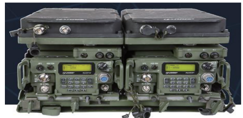
Fig.6 AN/VRC-118 radio station of MNVR for JTRS 图 6 JTRS 中 MNVR 电台 AN/VRC-118
