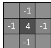
Fig.1 Laplace template when \Delta h = 1 图 1 当 \Delta h = 1 时的 Laplace 模板
